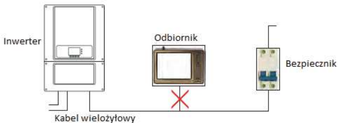
Rysunek 5-11 Nieprawidłowe podłączenie odbiorników elektrycznych
